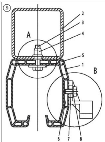
1. Blindnietmutter mit Loctite Nr. 2701 gegen Verdrehung sichern.
