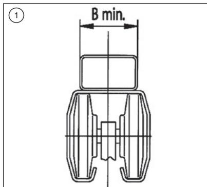
Die seitlichen senkrechten Unterholm-Profilkanten stabilisieren die Laufflächen der Tragrollen.
